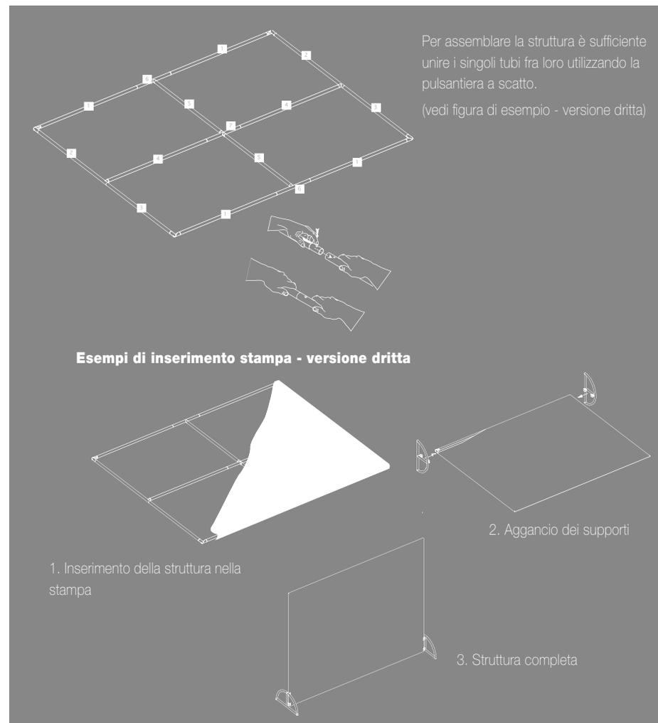
Per assemblare la struttura è sufficiente unire i singoli tubi fra loro utilizzando la pulsantiera a scatto.
